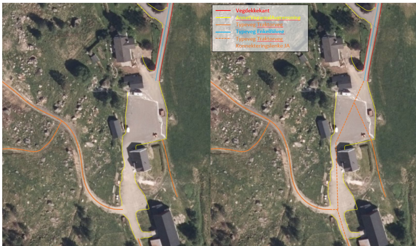
Figur 5. Eksempel på bruk av konnekteringslenke over gardstun i FKB-TraktorvegSti. Konnekteringslenker skal registreres fotogrammetrisk.
