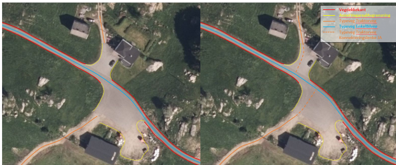
Figur 6. Eksempel på bruk av konnekteringslenke over gardstun i FKB-TraktorvegSti. Konnekteringslenker skal registreres fotogrammetrisk.
